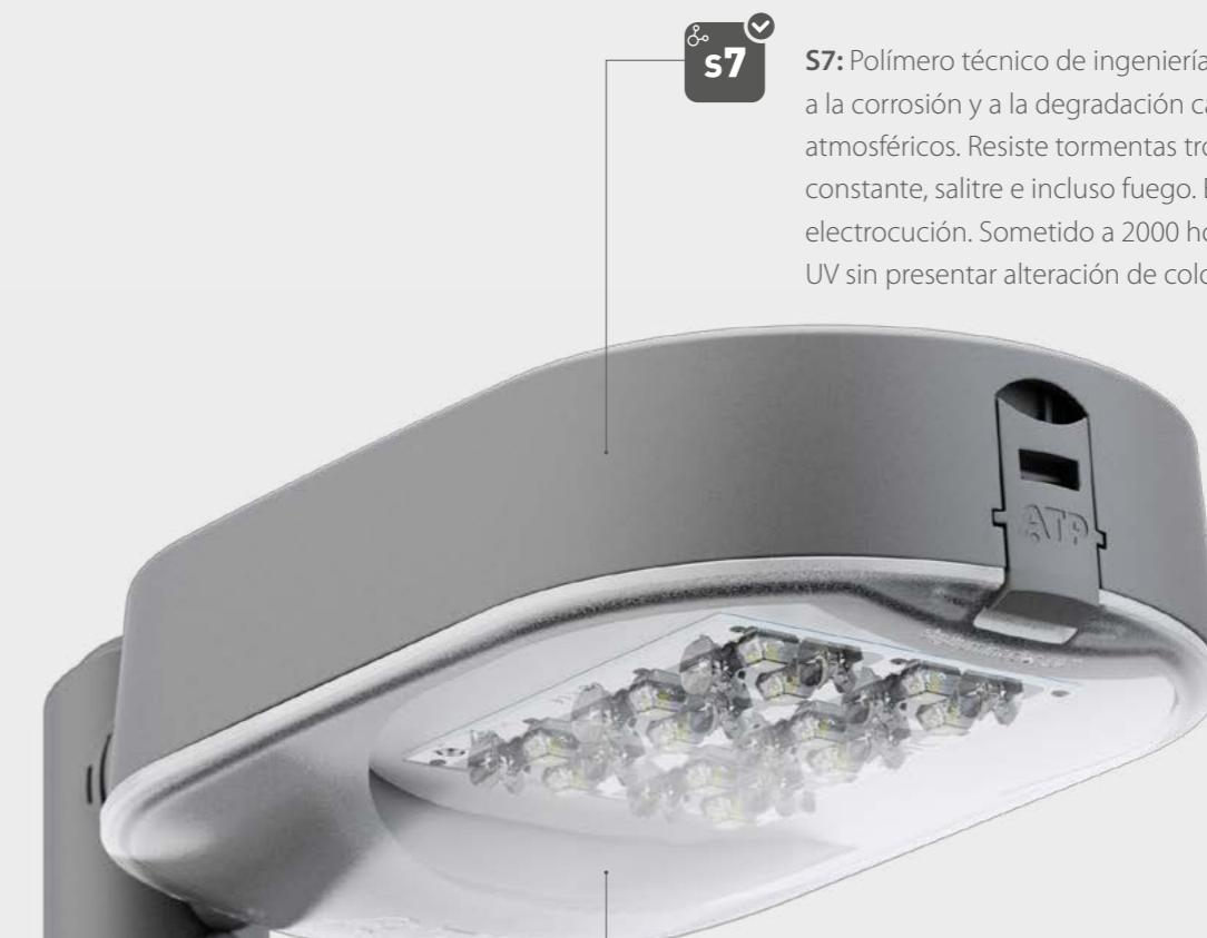
**S7:** Polímero técnico de ingeniería reforzado S7. Inmune a la corrosión y a la degradación causada por los agentes atmosféricos. Resiste tormentas tropicales, humedad constante, salitre e incluso fuego. Elimina el riesgo de electrocución. Sometido a 2000 horas en cámara de rayos UV sin presentar alteración de color.
