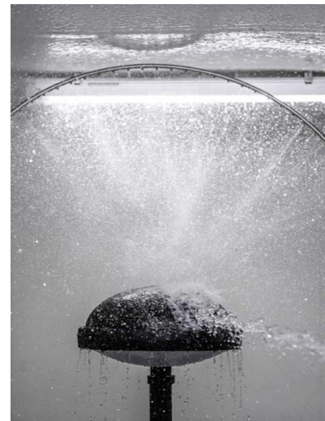
Ensaya ATP: proyección de agua desde todos los ángulos a un promedio de 100 l/min con una presión de 100 kN/m<sup>2</sup>.
