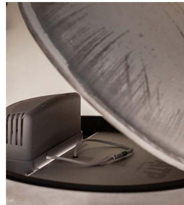
Ensaya ATP: nube en movimiento continuo de 2 kg/m<sup>3</sup> de polvo de diámetro inferior a 75 µm.
