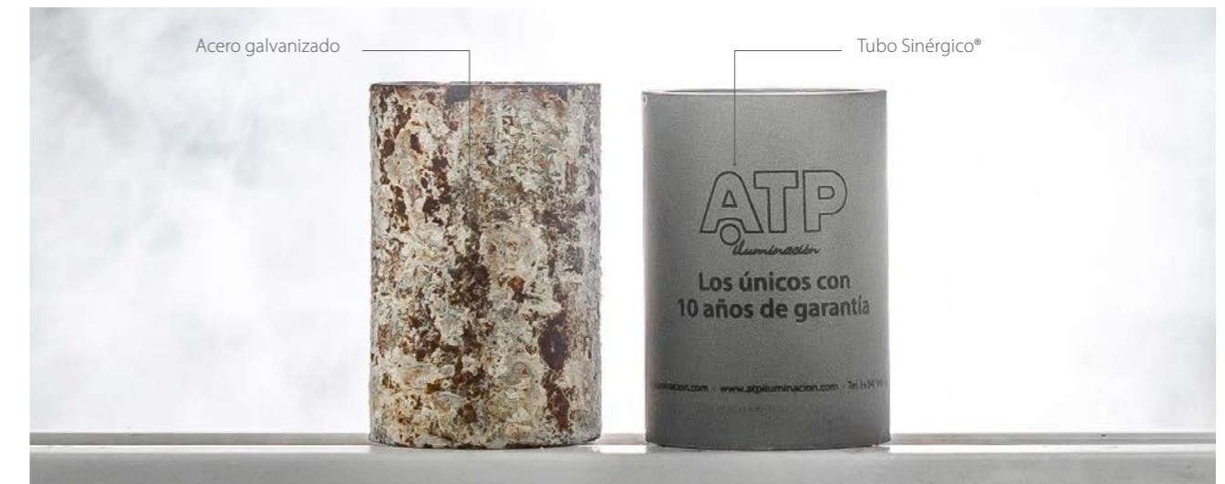
Sección de columna de acero galvanizado de otro fabricante y Tubo Sinérgico® de ATP, ambos tras 2000 horas de exposición en cámara de niebla salina.
