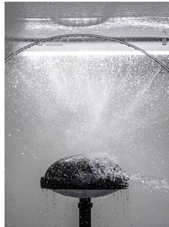
Ensayo ATP: proyección de agua desde todos los ángulos a un promedio de 100 l/min con una presión de 100 kN/m<sup>2</sup>.
