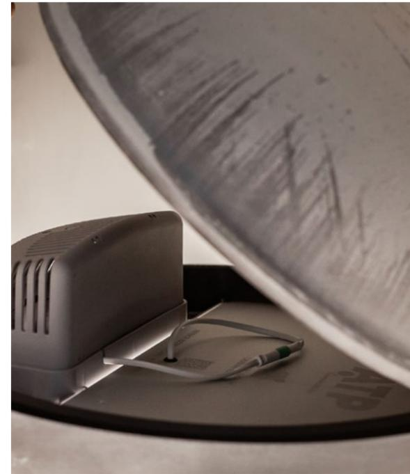
Ensayo ATP: nube en movimiento continuo de 2 kg/m<sup>3</sup> de polvo de diámetro inferior a 75 µm.
